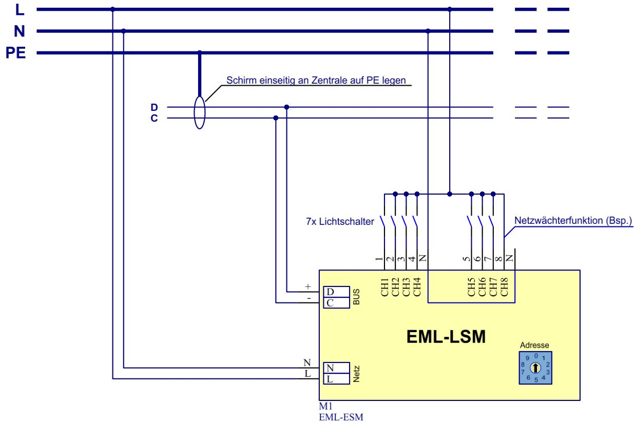
Die Null-Leiteranschlüsse sind intern gebrückt. Es reicht also ein Anschluss.
