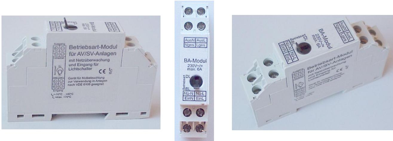
Die Betriebsart ist über einen Kipp-Schalter wählbar (BL/DL). Die Eingangskreise des Netzwächters und des Lichtschalter-Einganges sind mit Optokoppler realisiert. Dadurch ist eine leistungsarme Steuerung des Moduls möglich.
